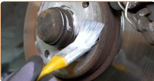
**22** Die Bremsscheibenoberfläche reinigen. Benutzen Sie einen Bremsenreiniger.
