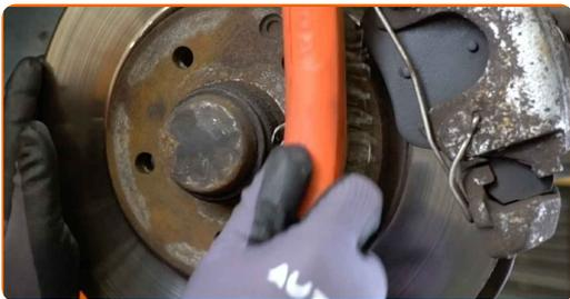
**21** Behandeln Sie die Oberfläche, an der die Bremsscheibe die Felge berührt. Verwenden Sie Keramikfett.
