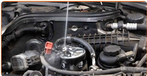
**20** Schrauben Sie den Befestigungssitz des Kraftstofffilters ein. Verwenden Sie Inbusschlüssel Nr. H5. Verwenden Sie einen Ratschenschlüssel.
