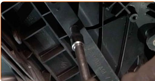
**3** Entfernen Sie den Gehäusedeckel des Innenraumfilters.
