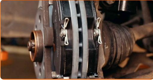
14 Behandeln Sie den Bremssattel-Kolben. Verwenden Sie eine Nylon-Reinigungsbürste. Benutzen Sie einen Bremsenreiniger.
