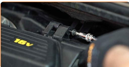
8 Entfernen Sie das Luftfiltergehäuse.
