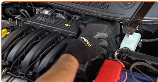
16 Schrauben Sie die Befestigungen des Luftfilterkastens ein. Verwenden Sie Stecknuss Nr. 10.
