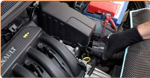
5 Entfernen Sie den Luftfilterkasten.
