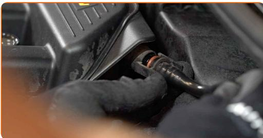
7 Schrauben Sie die Filtergehäuse-Befestigungsbolzen ab. Verwenden Sie den Torx T25.
