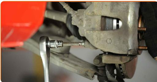
**35** Installieren Sie die Staubschutzkappen der Bremssattel-Führungsstifte.
