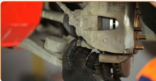
**36** Bauen Sie die Bremssattel-Haltefeder ein. Verwenden Sie eine Rundzange. Verwenden Sie einen flachen Schraubendreher.
