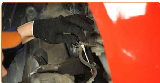
**11** Lösen Sie den Bremsschlauch vom Federbein.
