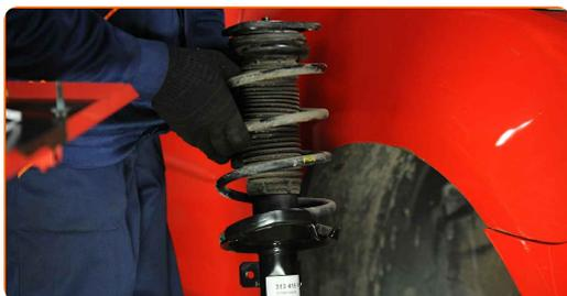
**39** Sichern Sie die oberen Befestigungen des Federbeines (3 Stück).
