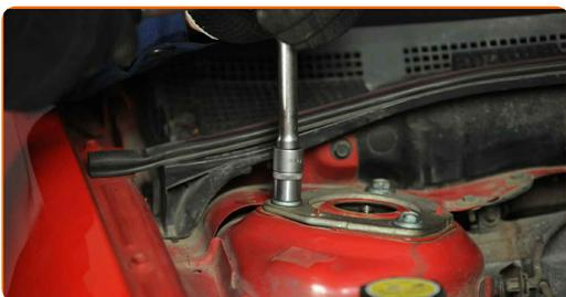
**41** Behandeln Sie die Befestigungselemente des Federbeinstützlagers. Benutzen Sie ein Kupferschmiermittel.
