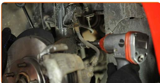
**14** Entfernen Sie die Befestigungsschraube.
