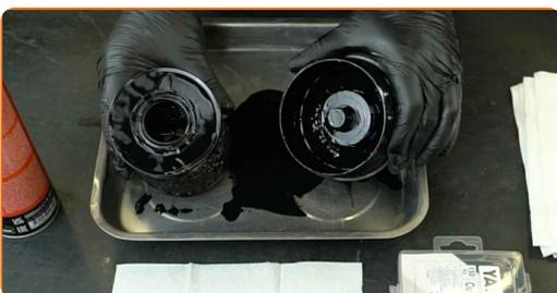
**13** Reinigen Sie den Ölfilterdeckel. Verwenden Sie ein Allzweck-Reinigungsspray.
