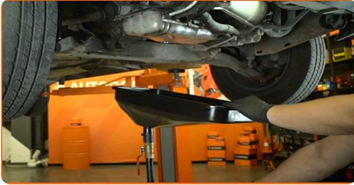
**7** Reinigen Sie den Bereich um die Ablassöffnung der Ölwanne. Benutzen Sie eine Drahtbürste. Verwenden Sie ein Allzweck-Reinigungsspray.
