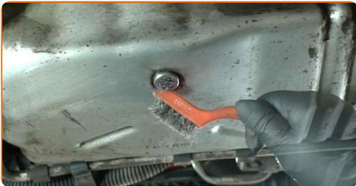
**8** Schrauben Sie die Ablassschraube ab. Verwenden Sie einen Vierkant-Steckschlüssel für Ölablassschrauben mit einem Durchmesser von 8 mm. Verwenden Sie einen Ratschenschlüssel.
