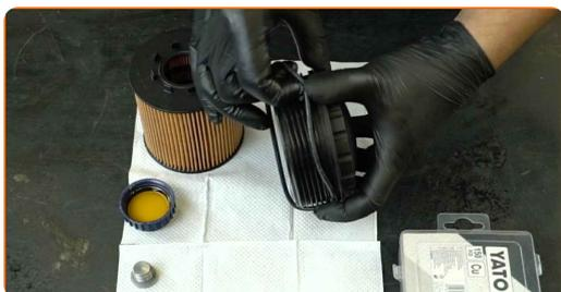
**17** Setzen Sie einen neuen Filtereinsatz in den Ölfilterdeckel ein.
