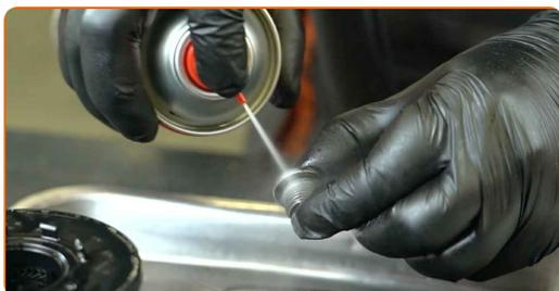
**16** Setzen Sie einen neuen O-Ring auf den Ölfilterdeckel.
