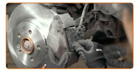
Bringen Sie die Halteclips der Bremsbeläge an. Verwenden Sie einen Splintentreiber. Verwenden Sie einen Gummi-Hammer.
