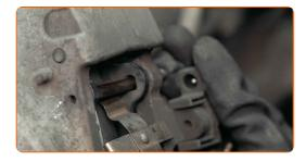
Bauen Sie den Verschleißsensor auf den Bremsbelägen ein.
