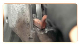
Austausch: Bremsbelagverschleißsensor – Mercedes ML W163. Tipp von AUTODOC-Experten:
