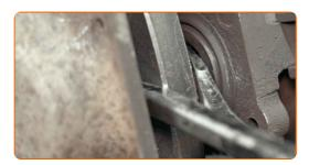
Reinigen Sie die Oberfläche des Bremssattels. Benutzen Sie eine Drahtbürste. Benutzen Sie einen Bremsenreiniger.
