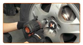
Senken Sie das Auto und ziehen Sie die Radschrauben über Kreuz an. Verwenden Sie eine Schlagnuss für Felgen # 17. Verwenden Sie einen Drehmomentschlüssel. Ziehen Sie ihn mit 150 Nm Drehmoment fest.
