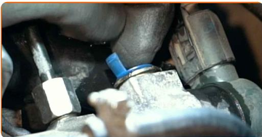
**10** Lösen Sie die Befestigungselemente der Motor-Unterdruckleitung. Verwenden Sie Stecknuss Nr. E11. Verwenden Sie einen Ratschenschlüssel.
