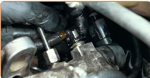
**22** Ziehen Sie die Befestigungselemente der Motor-Unterdruckleitung an. Verwenden Sie Stecknuss Nr. E11. Verwenden Sie einen Ratschenschlüssel.
