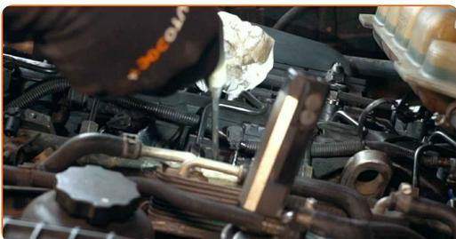
**13** Schrauben Sie die Glühkerzen aus. Verwenden Sie die Zündkerzennuss # 10. Verwenden Sie einen Drehmomentschlüssel.
