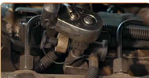
**11** Lösen Sie die Steckverbinder der Glühkerzenverkabelung. Verwenden Sie eine Spitzzange.
