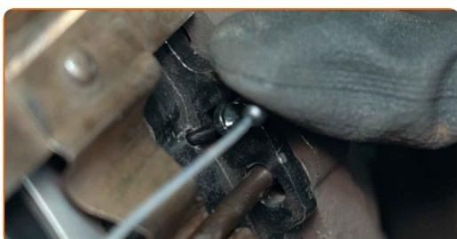
**19** Bringen Sie den Steckverbinder des Verschleißsensors der Bremsbeläge an.
