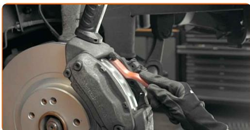
**Austausch: Bremsbelagverschleißsensor – Mercedes ML W163. Tipp von AUTODOC:**
