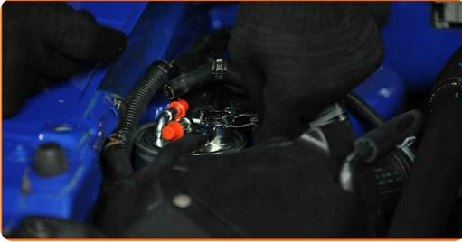
**12** Schließen Sie die Kraftstoffversorgungsleitungen an den neuen Kraftstofffilter an.
