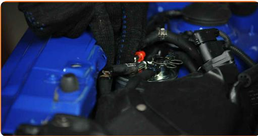
**13** Ziehen Sie die Befestigung der Kraftstoffzuleitung an. Verwenden Sie Zangen.
