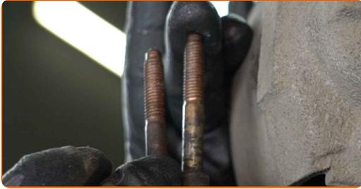
25 Ziehen Sie die Bremssattelbefestigungen fest. Verwenden Sie Inbusschlüssel Nr. H6. Verwenden Sie einen Drehmomentschlüssel. Ziehen Sie ihn mit 25 Nm Drehmoment fest.
