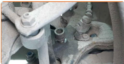
**26** Ziehen Sie die Befestigungen des Bremssattelhalters fest. Benutzen Sie den XZN #14. Verwenden Sie einen Drehmomentschlüssel. Ziehen Sie ihn mit 90 Nm Drehmoment fest.
