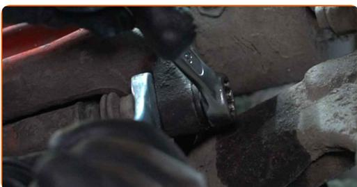
**9** Entfernen Sie die Befestigungsschrauben.
