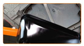
Reinigen Sie den Befestigungssitz des Kraftstofffilters. Benutzen Sie eine Drahtbürste. Benutzen Sie WD-40-Spray.
