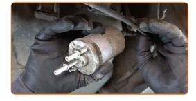
Reinigen Sie die Kraftstoffleitungen. Verwenden Sie Allzweckreinigungsspray.
