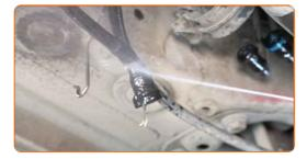
Installieren Sie einen neuen Kraftstofffilter.
