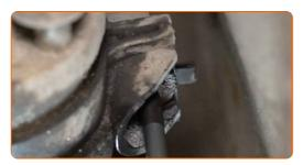
Reinigen Sie die Befestigungen der Kraftstoff-Zuleitungen. Verwenden Sie eine Nylon-Reinigungsbürste. Verwenden Sie Allzweckreinigungsspray.
