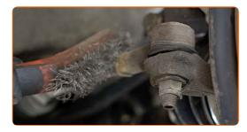
Lösen Sie die Kontermutter, die den Spurstangenkopf auf der Spurstange fixiert. Verwenden Sie Ring-Gabelschlüssel Nr. 19. Verwenden Sie Ring-Gabelschlüssel Nr. 22.
