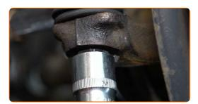
Ziehen Sie die Befestigungsmutter an, die den Spurstangenkopf mit dem Achsschenkel verbindet. Verwenden Sie Stecknuss Nr. 19. Verwenden Sie einen Drehmomentschlüssel. Ziehen Sie ihn mit 45 Nm Drehmoment fest.
