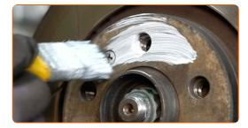
Die Bremsscheibenoberfläche reinigen. Benutzen Sie einen Bremsenreiniger.
