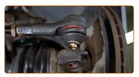
Bringen Sie den Spurstangenkopf in die richtige Position und fixieren Sie ihn mit einer Gegenmutter. Verwenden Sie einen Messschieber. Verwenden Sie Ring-Gabelschlüssel Nr. 19. Verwenden Sie Ring-Gabelschlüssel Nr. 22.
