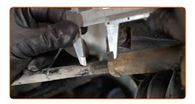
Reinigen Sie alle Verbindungsstücke des Spurstangenkopfes. Benutzen Sie eine Drahtbürste. Benutzen Sie WD-40-Spray.
