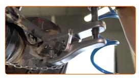
Schrauben Sie den Spurstangenkopf von der Spurstange ab.
