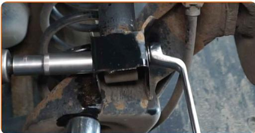
**9** Entfernen Sie die Befestigungsschraube.
