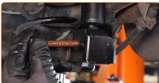
**29** Schrauben Sie das untere Befestigungselement des Stoßdämpfers ein. Verwenden Sie Ring-Gabelschlüssel Nr. 16 (2 Teile). Verwenden Sie einen Ratschenschlüssel.
