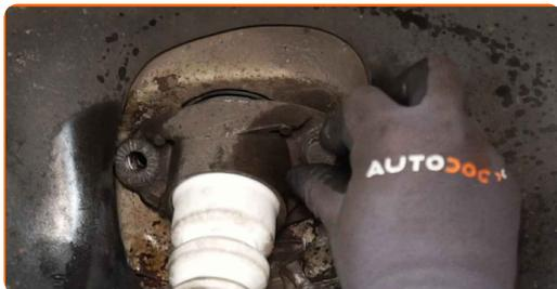
**27** Schrauben Sie die Befestigungen des Stoßdämpferlagers an. Verwenden Sie Stecknuss Nr. 16. Verwenden Sie einen Ratschenschlüssel.
