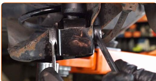
**30** Zum korrekten Anziehen der Befestigungen müssen Sie die Komponenten der Aufhängung in ihre Arbeitsposition heben. Benutzen Sie einen hydraulischen Getriebeheber.
