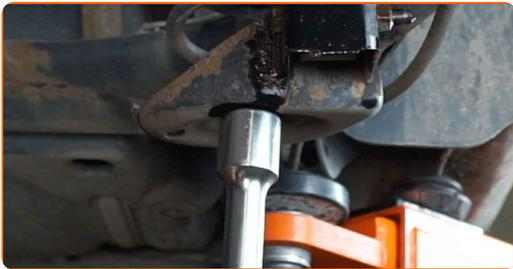
**8** Schrauben Sie den unteren Befestigungen des Stoßdämpfers ab. Verwenden Sie Ring-Gabelschlüssel Nr. 16. Verwenden Sie Stecknuss Nr. 16. Verwenden Sie einen Ratschenschlüssel.
