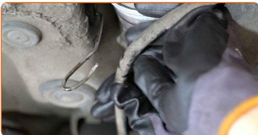
**7** Lockern Sie die Befestigungen des Kraftstofffilters. Verwenden Sie Stecknuss Nr. 7. Verwenden Sie einen Ratschenschlüssel.
