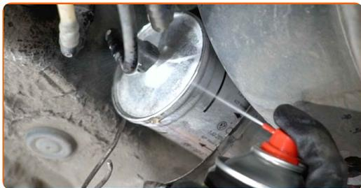
**9** Lösen Sie die Kraftstoffzulaufleitungen vom Kraftstofffilter. Verwenden Sie Kraftstoffleitungszangen.
