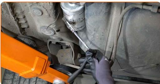
**8** Reinigen Sie die Befestigungen der Kraftstoff-Zuleitungen. Verwenden Sie Allzweckreinigungsspray.
