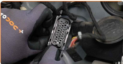
**18** Lösen Sie den Kabelbaum des elektrischen Fensterhebers. Verwenden Sie einen Lösehebel, um die Clips zu entfernen.
