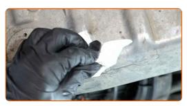
Schrauben Sie die neue Ablassschraube ein und ziehen Sie sie fest. Verwenden Sie Stecknuss Nr. 19. Verwenden Sie einen Drehmomentschlüssel. Ziehen Sie ihn mit 30 Nm Drehmoment fest.
