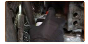
Schrauben Sie den Ölfilter ab. Verwenden Sie Steckschlüssel 76-14F. Verwenden Sie einen Ratschenschlüssel.
