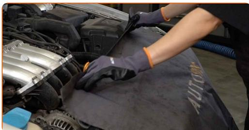
**3** Lösen Sie den Steckverbinder des Luftmassenmessers.
