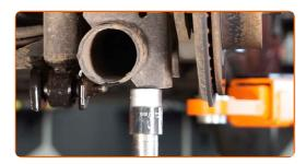
Entfernen Sie die Befestigungsschraube. Verwenden Sie Ring-Gabelschlüssel Nr. 18. Verwenden Sie Stecknuss Nr. 18.
