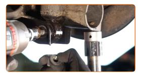
Schrauben Sie das obere Befestigungselement des Stoßdämpfers ab.
