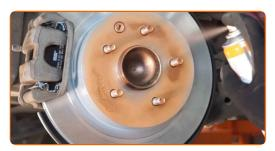
Die Bremsscheibenoberfläche reinigen. Benutzen Sie einen Bremsenreiniger.
