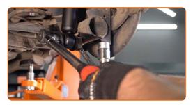
Die Montage unter dem Hinterachsträger entfernen.
