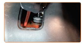
14 Den Stoßdämpfer entfernen.
