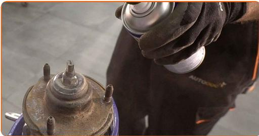
**25** Entfernen Sie die Stangenmutter des Federkolben. Verwenden Sie Ring-Gabelschlüssel Nr. 17. Benutzen Sie einen Rollgabelschlüssel.
