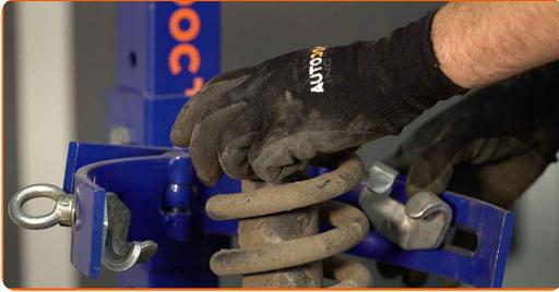
**28** Installieren Sie die Feder am Stoßdämpfer.
