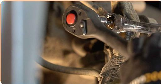
**10** Schrauben Sie die Befestigungen der Stabilisatorbuchsenhalter heraus. Verwenden Sie Stecknuss Nr. 14.
