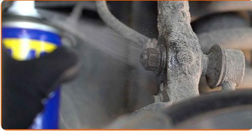
**9** Schrauben Sie die Befestigungen heraus, die die Koppelstange mit dem Achsschenkel verbinden. Verwenden Sie Stecknuss Nr. 17. Verwenden Sie Ring-Gabelschlüssel Nr. 17. Verwenden Sie Inbusschlüssel Nr. H6.
