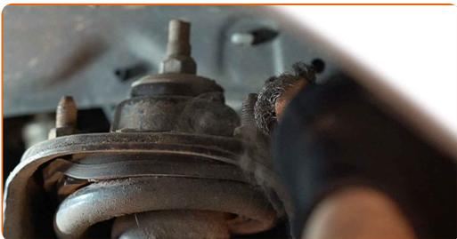
**18** Schrauben Sie die untere Befestigung der Stoßdämpferstrebe ab. Verwenden Sie Ring-Gabelschlüssel Nr. 14. Entfernen Sie die Befestigungsschraube.
