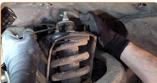
**19** Lösen Sie den unteren Bereich des Federbeins. Benutzen Sie ein Brecheisen.
