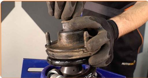
**31** Ziehen Sie die Federbeinkolbenstangenmutter an. Verwenden Sie Ring-Gabelschlüssel Nr. 17. Benutzen Sie einen Rollgabelschlüssel. Verwenden Sie einen Drehmomentschlüssel. Ziehen Sie ihn mit 25 Nm Drehmoment fest.
