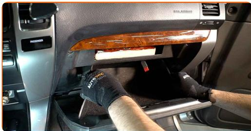
**4** Entfernen Sie das Luftfiltergehäuse.
