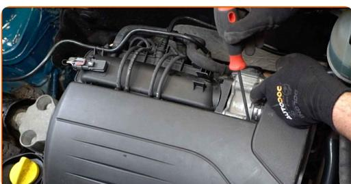
**18** Verbinden Sie den Entlüftungsschlauch.
