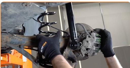
**19** Sichern Sie den Hinterachsträger. Benutzen Sie einen hydraulischen Getriebeheber.
