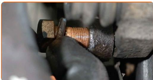
**27** Ziehen Sie die Befestigungen des Bremssattelhalters fest. Verwenden Sie Stecknuss Nr. 19. Verwenden Sie einen Drehmomentschlüssel. Ziehen Sie ihn mit 80 Nm Drehmoment fest.
