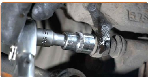
**9** Entfernen Sie die Bremssattelführungsbolzen.
