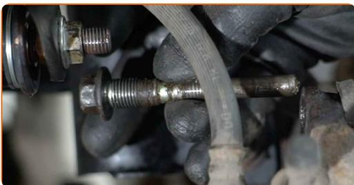
**10** Entfernen Sie den Bremssattel.
