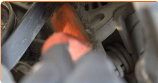
**15** Lockern Sie die Befestigungen der Lichtmaschine. Verwenden Sie Stecknuss Nr. 13. Verwenden Sie Stecknuss Nr. 16. Verwenden Sie einen Ratschenschlüssel.
