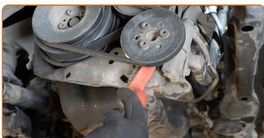
**11** Schrauben Sie die Befestigungen der hydraulischen Servopumpe ab. Verwenden Sie Stecknuss Nr. 13. Verwenden Sie Stecknuss Nr. 16. Verwenden Sie einen Ratschenschlüssel.
