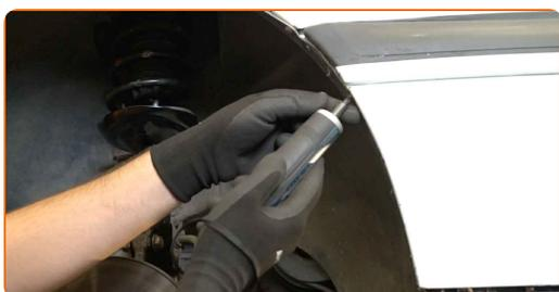
**9** Entfernen Sie die Radkastenabdeckung.
