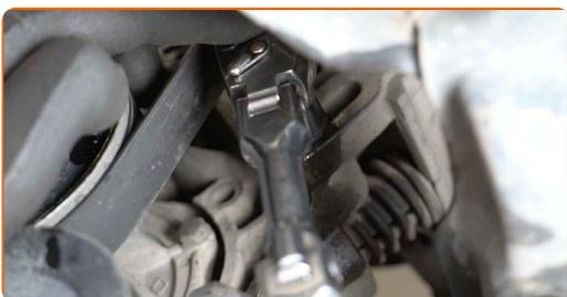
**16** Entfernen Sie den Keilrippenriemen.
