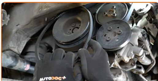
**14** Reinigen Sie die Befestigungen der Lichtmaschine. Benutzen Sie eine Drahtbürste. Benutzen Sie WD-40-Spray.
