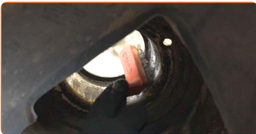
**31** Installieren Sie das Federbein am Radlauf.
