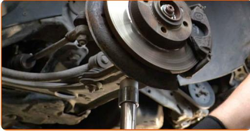
**16** Entfernen Sie die Befestigungsschrauben.
