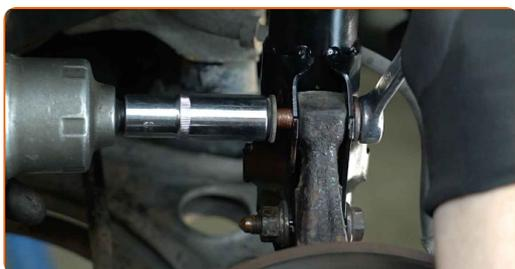
**37** Ziehen Sie die unteren Befestigungen an, die das Federbein mit dem Achsschenkel verbinden. Verwenden Sie Ring-Gabelschlüssel Nr. 18. Verwenden Sie Stecknuss Nr. 18. Verwenden Sie einen Drehmomentschlüssel. Ziehen Sie ihn mit 95 Nm Drehmoment fest.
