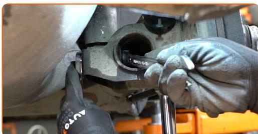
**22** Ziehen Sie die untere Befestigung des Stoßdämpfers an. Verwenden Sie Ring-Gabelschlüssel Nr. 17. Verwenden Sie Stecknuss Nr. 17. Verwenden Sie einen Drehmomentschlüssel. Ziehen Sie ihn mit 70 Nm Drehmoment fest.
