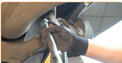
**23** Schrauben Sie die obere Befestigung des Federbeinbefestigung an. Schrauben Sie diese nicht fest.
