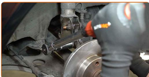
**37** Befestigen Sie den Bremsschlauch an der Strebe.
