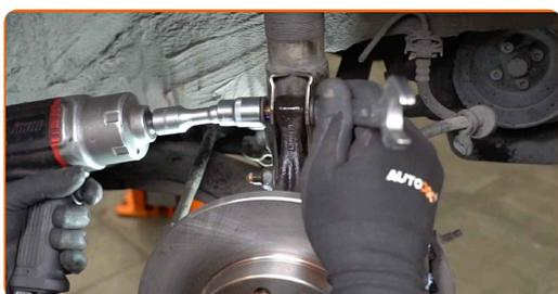
**35** Entfernen Sie den Träger unter dem Achsschenkel.
