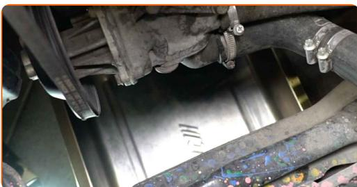
**5** Lockern Sie die Klemme des Kühlmittelschlauchs. Verwenden Sie Stecknuss Nr. 7. Verwenden Sie einen Ratschenschlüssel.
