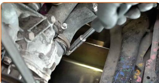
**6** Lösen Sie den Kühlmittelschlauch.
