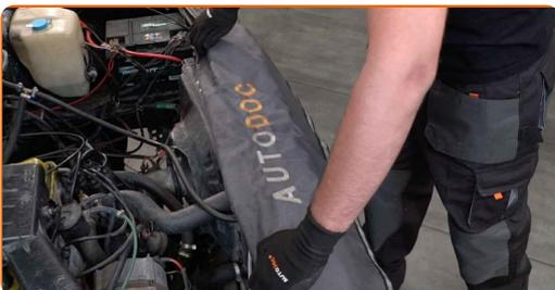
**3** Schrauben Sie den Deckel des Kühlmittelbehälters ab.
