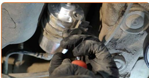
**13** Reinigen Sie die Befestigungen der Kraftstoff-Zuleitungen. Verwenden Sie Allzweckreinigungsspray.
