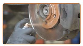
Die Bremsscheibenoberfläche reinigen. Benutzen Sie einen Bremsenreiniger.
