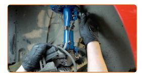
Ziehen Sie das Befestigungselement an, das die Druckstange mit dem Federbein verbindet. Verwenden Sie Ring-Gabelschlüssel Nr. 17. Verwenden Sie Stecknuss Nr. 17. Verwenden Sie einen Drehmomentschlüssel. Ziehen Sie ihn mit 40 Nm Drehmoment fest.
