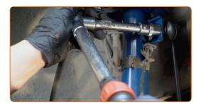
Ziehen Sie das Befestigungselement an, das die Druckstange mit dem Stabilisator verbindet. Verwenden Sie Ring-Gabelschlüssel Nr. 17. Verwenden Sie Stecknuss Nr. 17. Verwenden Sie einen Drehmomentschlüssel. Ziehen Sie ihn mit 40 Nm Drehmoment fest.
