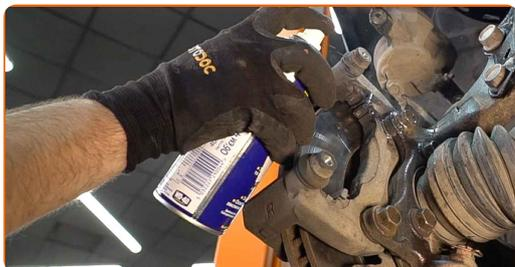
**15** Lösen Sie die Befestigung der Sattelhalterung. Verwenden Sie Stecknuss Nr. 17. Verwenden Sie einen Ratschenschlüssel.
