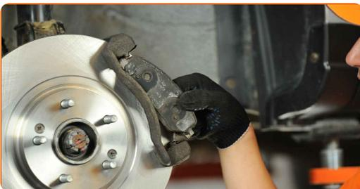
**13** Entfernen Sie die Halteclips der Bremsbeläge.
