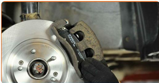
**31** Schrauben Sie die Führungsbolzen hinein.
