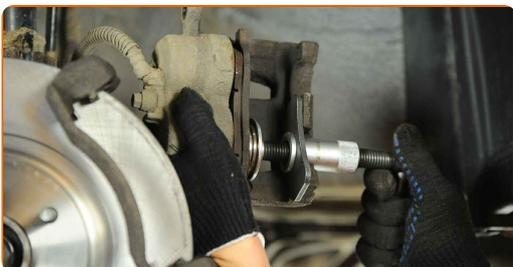
**30** Installieren Sie den Bremssattel und fixieren Sie diesen.
