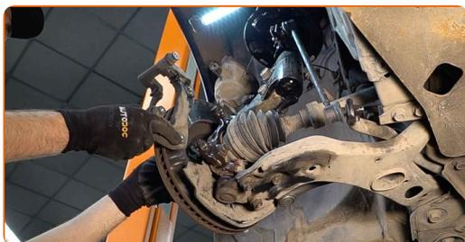
**17** Reinigen Sie die Bremsscheibenbefestigung. Benutzen Sie eine Drahtbürste. Benutzen Sie WD-40-Spray.
