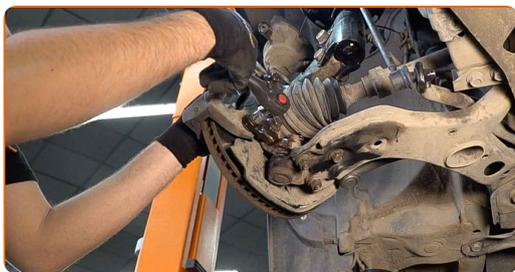
**16** Entfernen Sie die Sattelhalterung.
