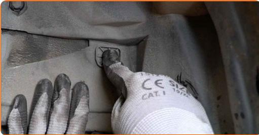
**18** Ziehen Sie die Befestigungen der unteren Ölwanne-Abdeckung fest. Verwenden Sie einen Kreuzschlitzschraubendreher.
