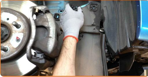
7 Ziehen Sie die Spannrolle des Keilrippenriemens beiseite. Verwenden Sie Ring-Gabelschlüssel Nr. 14.
