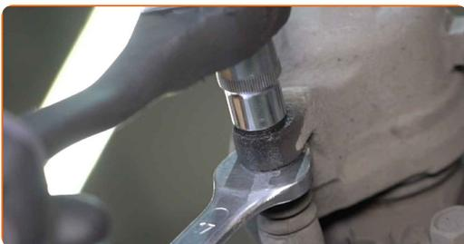
**13** Entfernen Sie die Befestigungsschrauben.
