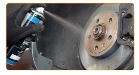
Die Bremsscheibenoberfläche reinigen. Benutzen Sie einen Bremsenreiniger.
