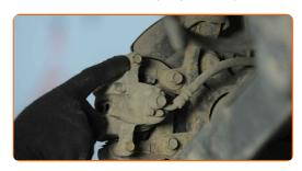
Schrauben Sie die Befestigung des Bremssattels ab. Verwenden Sie Ring-Gabelschlüssel Nr. 17. Verwenden Sie Stecknuss Nr. 12. Verwenden Sie einen Ratschenschlüssel.
