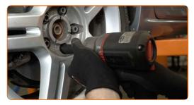
Senken Sie das Auto und ziehen Sie die Radschrauben über Kreuz an. Verwenden Sie eine Schlagnuss für Felgen # 19. Verwenden Sie einen Drehmomentschlüssel. Ziehen Sie ihn mit 108 Nm Drehmoment fest.
