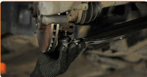
**21** Bringen Sie die Befestigungsschraube an. Verwenden Sie einen Splintentreiber. Benutzen Sie einen Hammer.
