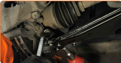
**23** Stützen Sie den Arm. Benutzen Sie einen hydraulischen Getriebeheber.
