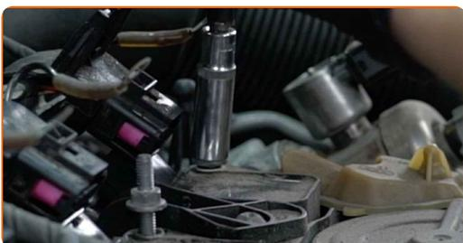
**6** Entfernen Sie die Befestigungsschrauben.
