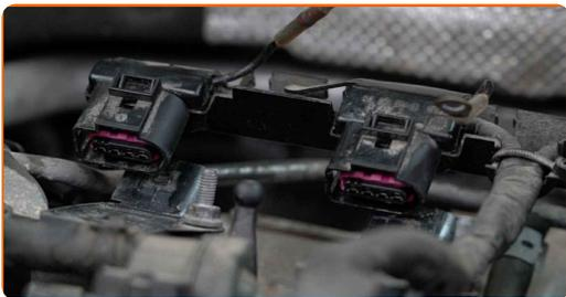
**5** Schrauben Sie die Befestigungsschrauben der Zündspulen ab. Verwenden Sie Stecknuss Nr. 10. Verwenden Sie einen Ratschenschlüssel.
