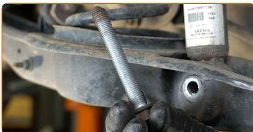
**20** Den Stoßdämpfer entfernen.
