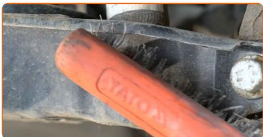
**7** Stützen Sie den hinteren Achsschenkel ab. Benutzen Sie einen hydraulischen Getriebeheber.
