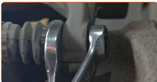
**9** Entfernen Sie die Befestigungsschrauben.
