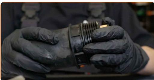
**19** Schmieren Sie die Gummidichtung des neuen Filters mit einer kleinen Menge frischen Öls.
