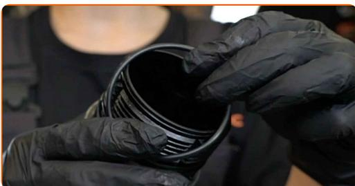
**18** Setzen Sie den neuen Ölfilter in den Montagesitz auf der Filterabdeckung ein.
