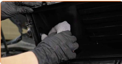
**11** Setzen Sie ein neues Filterelement in das Filtergehäuse.
