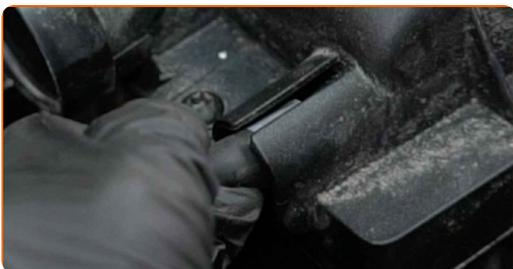
**15** Schließen Sie den Kurbelgehäuseentlüftungsschlauch an das Luftfiltergehäuse an.
