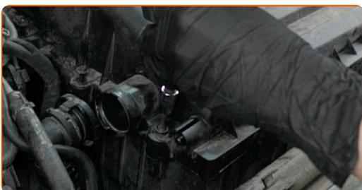
**14** Schließen Sie den Unterdruckschlauch an das Luftfiltergehäuse an.
