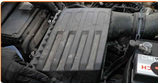
**13** Drehen Sie die Befestigungsschrauben der Luftfilter-Abdeckung ein. Verwenden Sie den Torx T25. Verwenden Sie einen Ratschenschlüssel.
