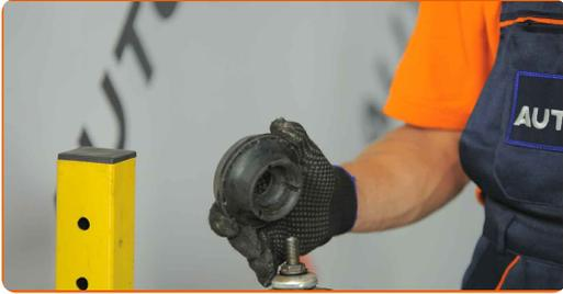
**21** Behandeln Sie die Federbeinstange. Benutzen Sie eine Drahtbürste. Benutzen Sie WD-40-Spray.
