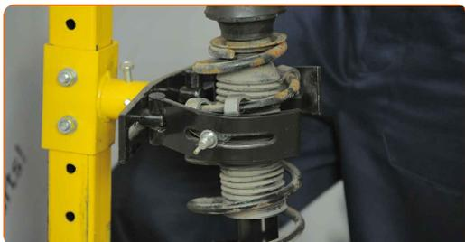
**20** Drehen Sie das Befestigungselement des Federbeinstützlagers auf.
