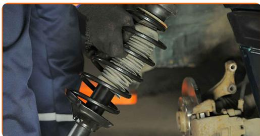
**34** Schrauben Sie die obere Befestigung des Federbeinbefestigung an.
