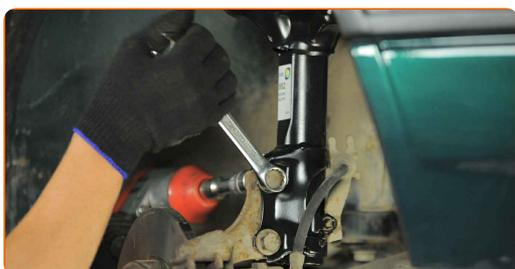
**11** Entfernen Sie die Befestigungsschrauben (2 Stück).
