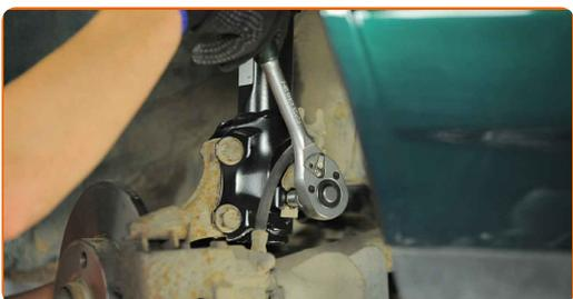
**8** Entfernen Sie die Halterung der Stoßdämpferstrebe.
