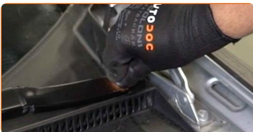
**15** Entfernen Sie die Kappe der Befestigung des hinteren Wischerarms.
