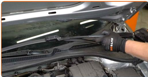
**8** Reinigen Sie die Stifte der Frontscheibenwischerarme. Benutzen Sie eine Drahtbürste. Benutzen Sie WD-40-Spray.
