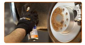
Die Bremsscheibenoberfläche reinigen. Benutzen Sie einen Bremsenreiniger.
