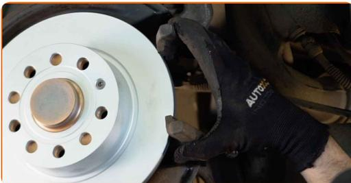
22 Befestigen Sie die Bremssattelhalterung. Benutzen Sie den XZN #12. Verwenden Sie einen Drehmomentschlüssel. Ziehen Sie ihn mit 90 Nm Drehmoment fest.
