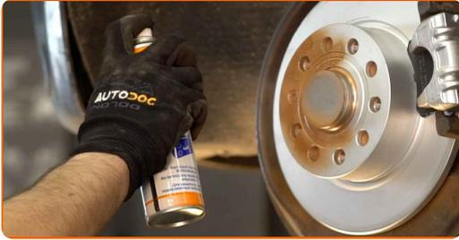
**28** Die Bremsscheibenoberfläche reinigen. Benutzen Sie einen Bremsenreiniger.
