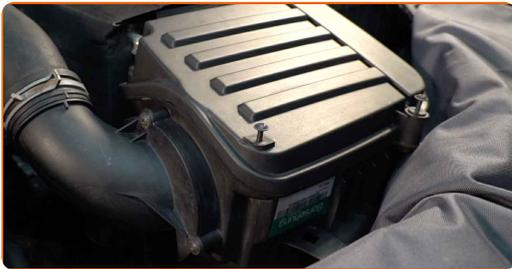
**13** Drehen Sie die Befestigungsschrauben der Luftfilter-Abdeckung ein. Verwenden Sie einen Kreuzschlitzschraubendreher.
