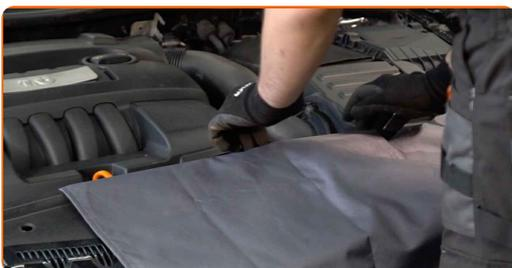
**3** Lösen Sie die Befestigungsschrauben der Luftfilter-Abdeckung. Verwenden Sie einen Kreuzschlitzschraubendreher.
