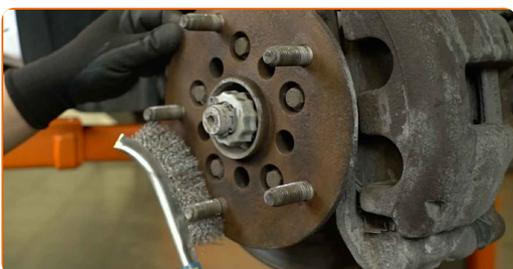
**25** Reinigen und schmieren Sie die Oberfläche der Radnabe, die die Felge berührt. Verwenden Sie Keramikfett.
