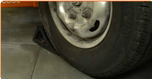
**2** Lockern Sie die Radmutter. Verwenden Sie eine Schlagnuss für Felgen mit einem Durchmesser von 21 mm. Verwenden Sie einen Drehstift.
